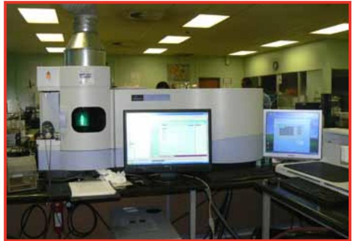
*Lors de l'analyse d'échantillons d'huile, le spectromètre par torche à plasma (ICP, inductively coupled plasma) fournit des données sur la contamination et les taux d'usure, données qui peuvent être utilisées dans le cadre du diagnostic holistique de l'échantillon.*
